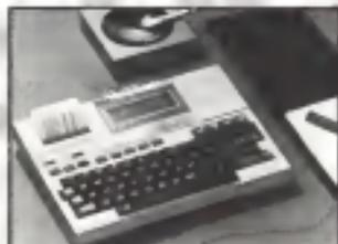
EPSON HX 20 computer portatile: stampante e display incorporati, 16 KBytes RAM min, microcassette, grafico
